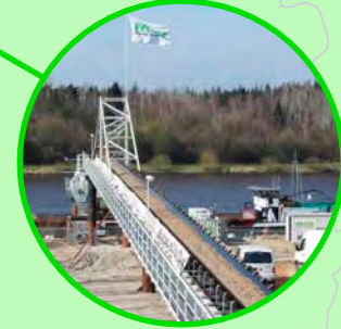
Met behulp van een telescopische transportband en storttrechter worden schepen beladen met zand uit het zanddepot in Beldorf
