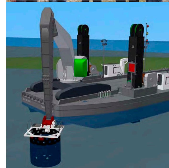
De duikring, die met een graafmachine op de Scheldeoord over de zeebodem wordt verplaatst, biedt de duikers een veilige werkomgeving
