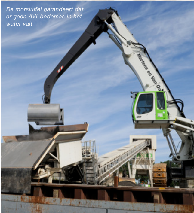
Snellere laadtijden en continuïteit bij het wisselen van schepen door het toepassen van een trechter
